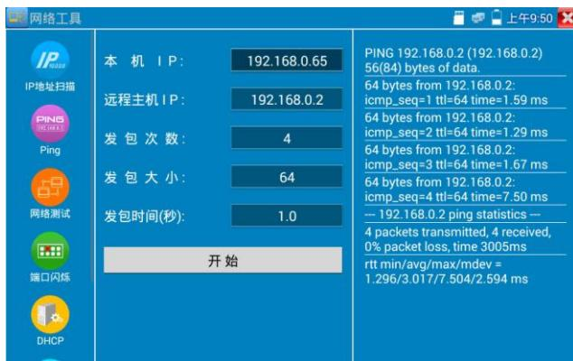
**实用性:** 维护网络设备时, 最常用的方法是用PING测试该设备工作是否正常、IP地址设置是否正确, IP摄像机或其他网络设备可以被PING得通, 才能进行正常网络通信。PING测试时, 第一个包可能会丢包, 这是正常现象。
