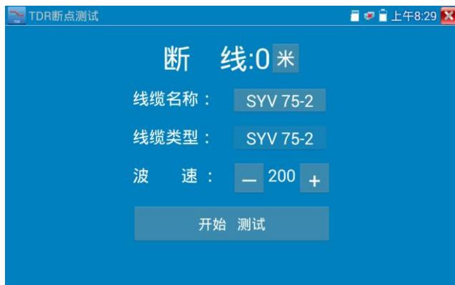
仪表内置BNC线缆、网线、RVV控制线、电话线、TVVB电梯视频线等线缆测试选项。用户可自行定
