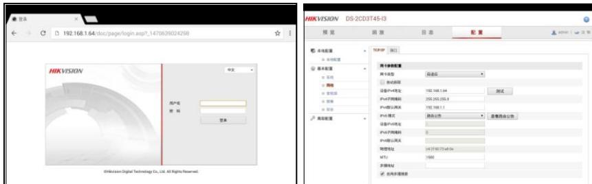
网络摄像机和仪表必须同一网段，浏览器才能登陆网络摄像机。如果通过浏览器修改网络摄像机的地址后，网络摄像机的IP地址与仪表地址不同网段，请等待会话结束并点击
