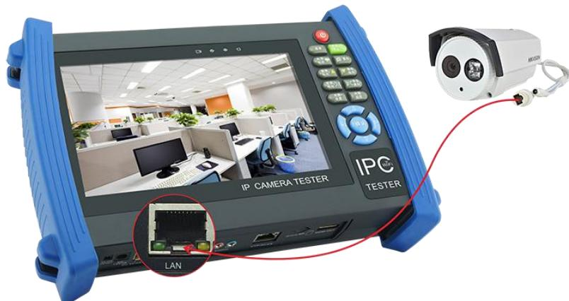
**注：**对于不提供外接电源的IP网络摄像机，因为它只支持PoE供电功能，可通过仪表的LAN端口为该网络摄像机提供PoE供电，供电时必须断开网络交换机与仪表的连接，即仪表的PSE端口不能连接任何网线。
