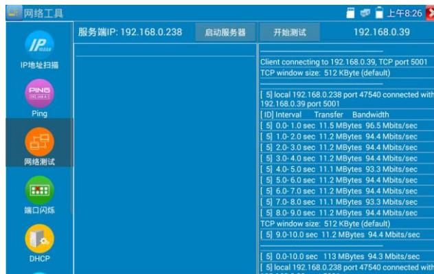
网络带宽测试，也可以用一个仪表和电脑进行测试。在电脑上安装网络带宽测试软件，作为测试端或服务器，与仪表进行对测。
