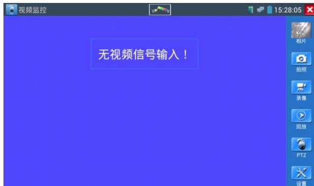
进入模拟视频监控测试界面，当有图像输入时，显示摄像机送过来的图像。在接收到摄像机或快球的图像时，可轻触上面菜单条的 进行视频电平测量；轻触右边“拍照”、“录像”、“相片浏览”、“录像回放”、“PTZ云台控制”、“色彩及存储设置”工具栏功能，进行相关操作。
