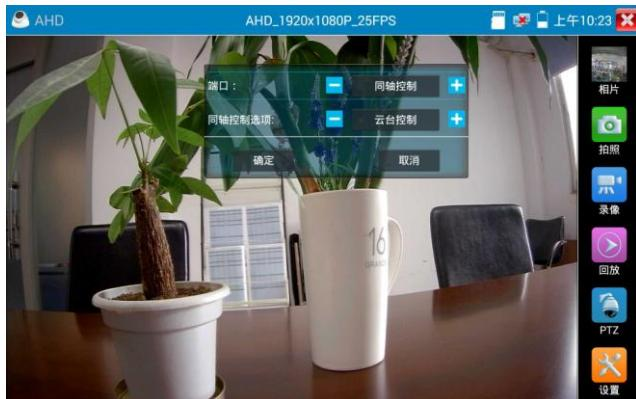
同轴控制选项，选择“云台控制”或“云台控制-2”进行云台控制。（AHD摄像机的云台控制有两种不同指令，如果不能进行云台控制，请切换另一种指令）
