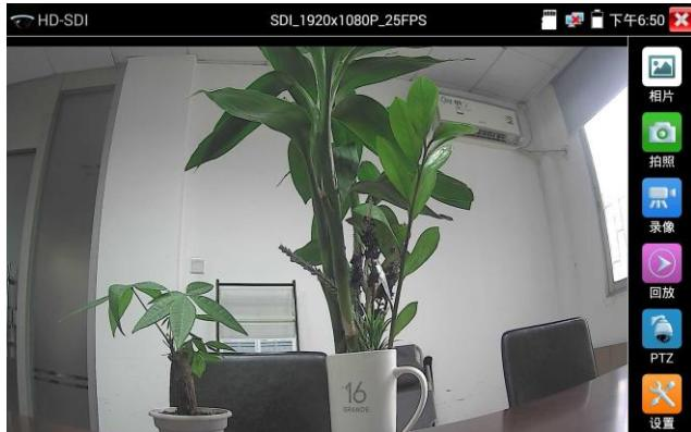
仪表接收到SDI摄像机图像，同时可以通过HDMI输出端口将图像送往高清电视机，可当SDI到HDMI转换器功能。
