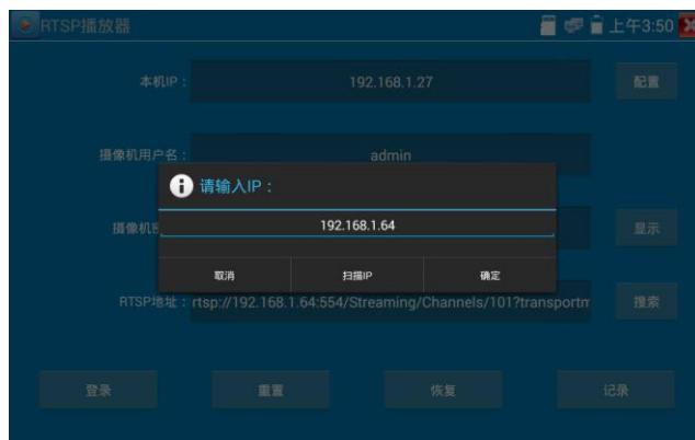
选择显示图像的码流类型，点击确定可观看图像（当摄像机分辨率大于 1920\*1080 的时候，可选用分辨率较小的子码流，此时可以流畅的观看图像）
