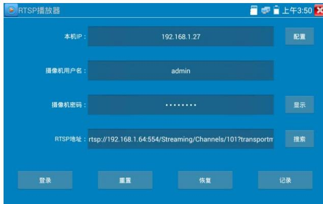
点击“RTSP 地址”后面的搜索，选中扫描到的摄像机的 IP 地址。仪表将扫描到网络摄像机的 RTSP 地址自动填入，客户也可以手动填入已知 RTSP 地址。
