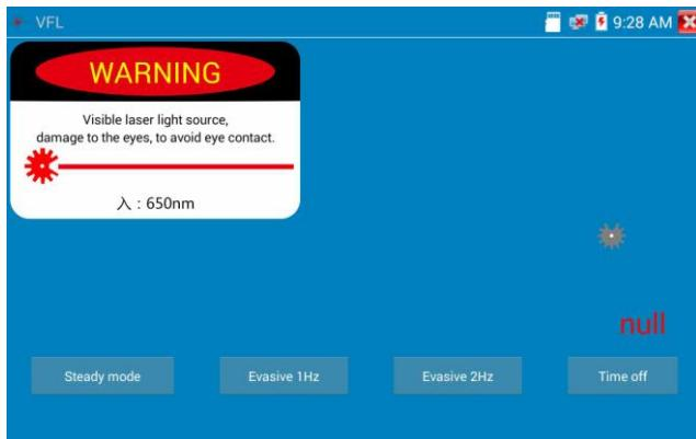
VFL提供四种使用状态——“常亮模式”、“闪烁1Hz”、“闪烁2Hz”和“定时关闭。点击“常亮模式”按钮，VFL进入常开的打开状态；点击“闪烁1Hz”、“闪烁2Hz”按钮，VFL进入闪烁的
