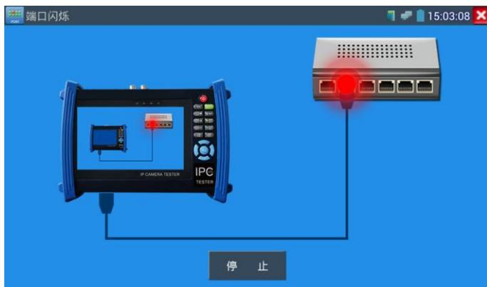
**实用性：**工程人员要检修插在交换机上的网线时，不能随意拔网线，如果拔错线会造成在用网络中断。用仪表在网线的另一端发送信号，对应的交换端口会按固定的频率闪烁，可明显区分其它在用的端口，快速定位该交换机端口，避免工程人员拔错线。
