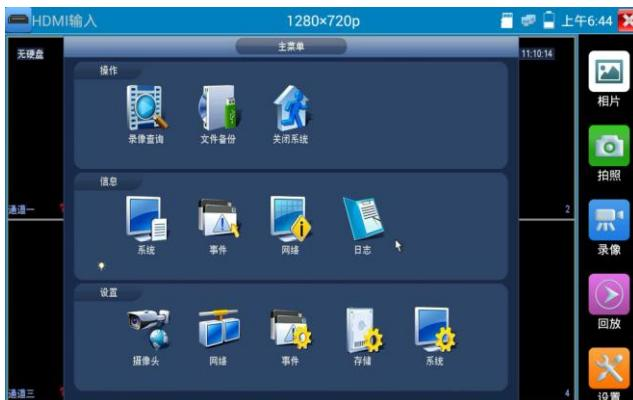
仪表接收HDMI图像时，顶部菜单条显示该图像的分辨率。在“设置”选项中的“分辨率”选项可进行分辨率设置。手指快速连续两次轻触屏幕，全屏显示图像。仪表支持分辨：
