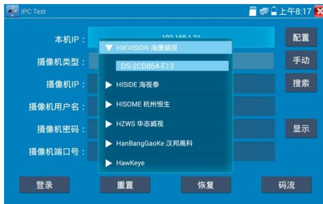
**码流：**使用RTSP码流播放摄像机图像，可选主码流或子码流进行图像测试。（如果摄像机RTSP服务未开启或没有此服务，将提示“智能匹配类型错误，请切换为手动选择类型”）
