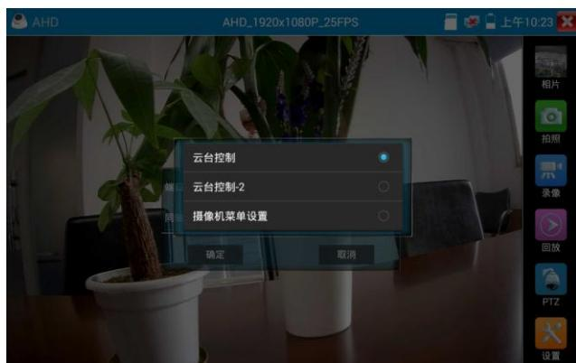
AHD摄像机同轴控制不需要进行参数设置即可进行云台控制。
