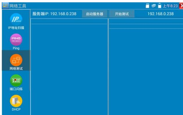
进行网络带宽测试时，必须有一个仪表当服务器或用电脑安装网络测试软件当服务器，另个仪表发包测试。两个测试仪表必须在同一网段上。
