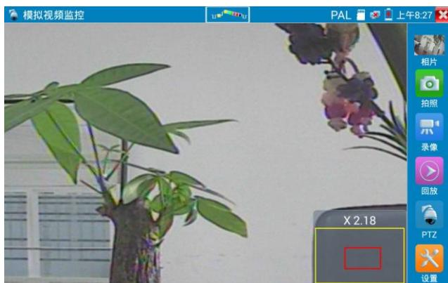
图像放大状态时，如果不用触摸操作，也可按键操作。按 图像放大；按 图
