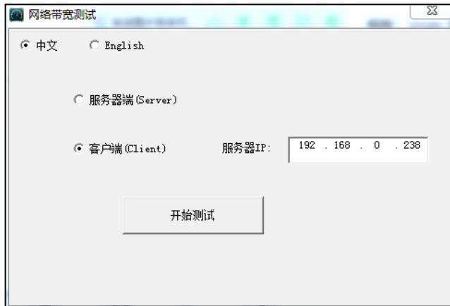
仪表作为测试端，仪表的IP地址为：192.168.0.230，与电脑服务器端是同一网段不同IP地址。在仪表的测试端填入服务器端的IP地址：192.168.0.89，点击“开始测试”进行网络带宽测试。
