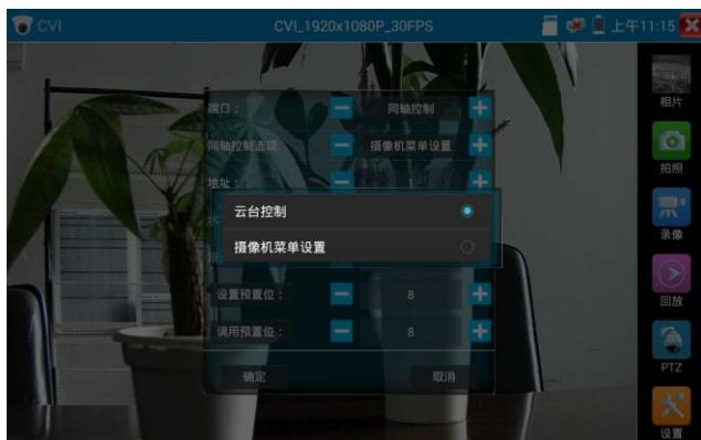
输入调用球机菜单的地址码，参数设置完成后，直接按键盘“光圈+”或点击屏幕中的“进入菜单”，可调出球机主菜单。（有部分摄像机点击“进入菜单”后无法直接打开菜单，需再点击键盘上的“确定”或屏幕上的“确定”键 打开菜单）
