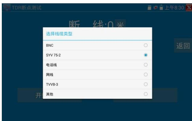
3. 点击“+”或“-”调整波速，当屏幕显示长度与实际长度相同时，点击屏幕右下方的“保存”，保存校准数据。线缆校准后，以后测试该线缆时可直接选择已校准的线缆名称进行测试，提高测试准确度。
