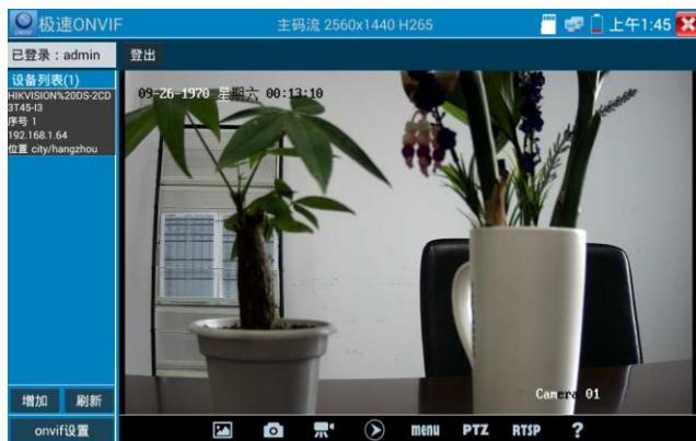
**视频直播：**点击“视频直播”，可直播网络摄像机的图像。双击图像显示区域，仪表全屏显示图像；全屏显示时，双击屏幕返回原来状态。
