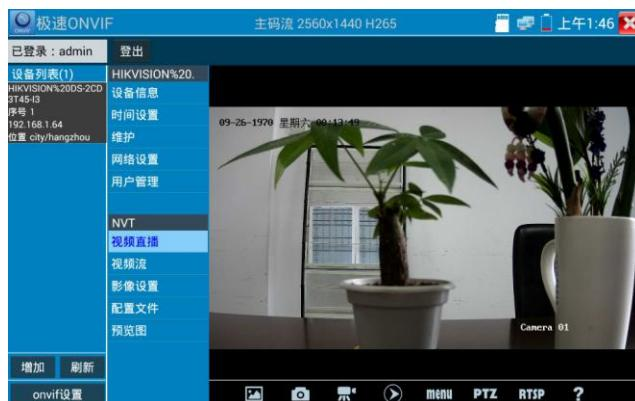
**云台控制：**手指在图像显示区域向左、右、上、下滑动，以及两手指向外滑动扩大、向内缩小，网络球机做相应的转动动作。图像显示区域的左上角，显示云台转动方向。
