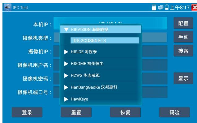
**码流：** 使用RTSP码流播放摄像机图像，可选主码流或子码流进行图像测试。（如果摄像机
