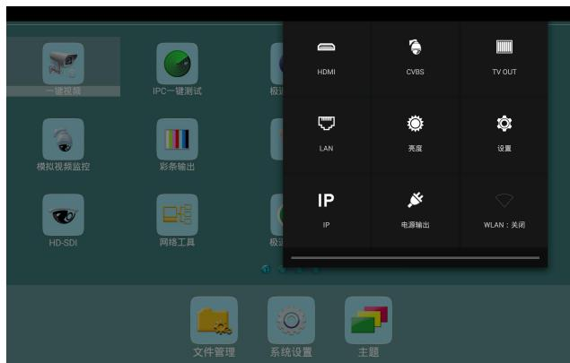
**HDMI:** 开启HDMI输入悬浮窗口，在观看网络摄像机图像时，开启HDMI悬浮窗口，可在观看网络摄像机的同时，观看HDMI输入画面。在任何应用功能界面，都可快速显示HDMI输入图像。
