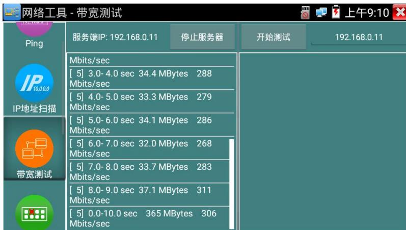
2. 开始发包测试：在发包测试端填写对端服务器的IP地址，点击“开始测试”。
