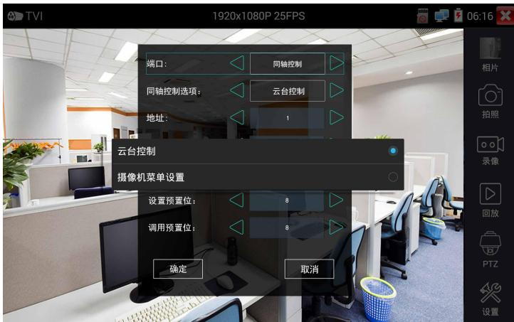
输入调用球机菜单的地址码，参数设置完成后，直接按键盘“确认” 或点击屏幕中的“确认”
