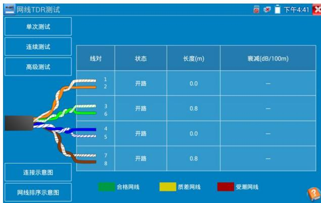
**单次测试：**测试线缆状态、长度和衰减。
