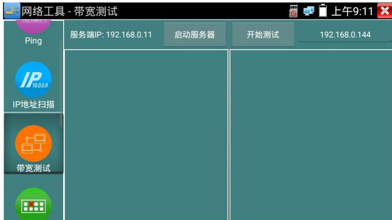
进行网络带宽测试时，必须有一个仪表当服务器或用电脑安装网络测试软件当服务器，另个仪表发包测试。两个测试仪表必须在同一网段上。
