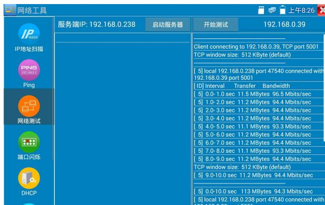
相反，也可以把仪表当服务器，电脑作为测试端（选客户端），填入仪表的IP地址，可以测试网络带宽。
