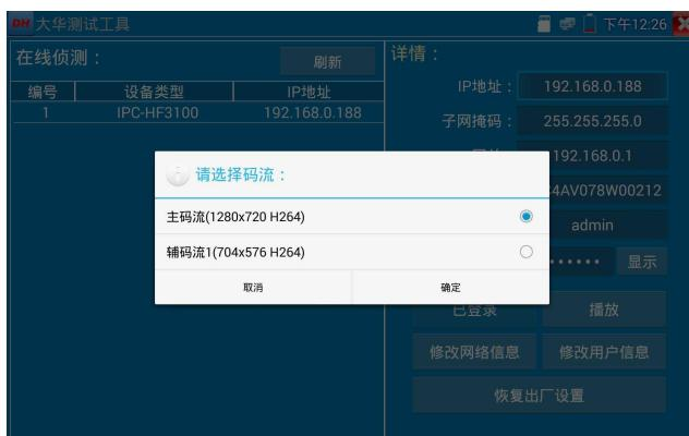
**修改网络信息：**修改摄像机IP地址、子网掩码、网关等参数。
