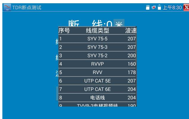
**用户自定义校准：**准备一段需校准的常用线缆，线缆长度不少于50米，建议用100–200米线缆进行校准。点击线缆名称栏进入线缆类型选择界面，手指滑动线缆类并选择“用户自定义 1”，共有11组自定义可选择，点击“校准”，进行校准。
