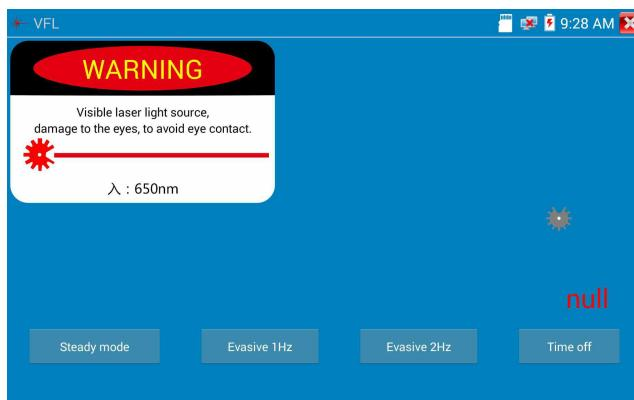
VFL提供四种使用状态——“常亮模式”、“闪烁1Hz”、“闪烁2Hz”和“定时关闭。点击“常亮模式”按钮，VFL进入常开的打开状态；点击“闪烁1Hz”、“闪烁2Hz”按钮，VFL进入闪烁的打开状态；点击“定时关闭”按钮，VFL立即关闭，可选择定时关闭时间。（时间有：5分钟、10分钟、30分钟、60分钟、120分钟。）用户可根据实际使用情况进行操作。
