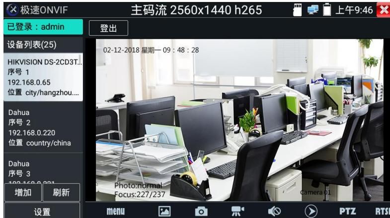
像机，在左边设备列表中列出摄像机名称和地址。仪表将自动登录并播放摄像机画面。默认使用admin密码自动登录，修改密码后，将使用修改后的密码自动进行登陆。
