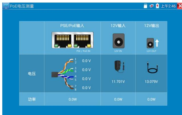
**⚠ 注意：仪表的12v电源输入接口，不能接入超过17v的电源，否则将损坏机器。**
