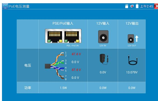
PoE供电设备的端口通过网线接入到仪表左侧的PSE IN端口，受电IP摄像机或无线AP设备接入到仪表左侧的LAN端口，仪表屏幕将显示供电电压的大小及线路连接情况。
