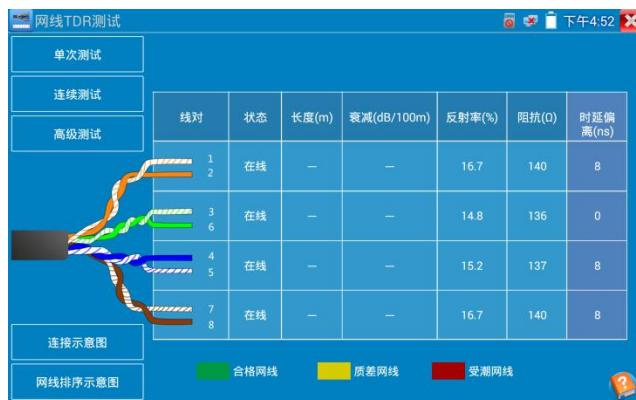
**高级测试：**测试线缆状态、长度和衰减、反射率、阻抗和时延偏离等参数。
