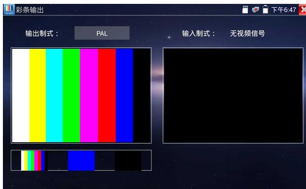
用手指向左右滑动或轻触下面的彩条、蓝色、黑色，可选择相应的图像输出；在屏幕上连击两次，全屏显示和输出。
