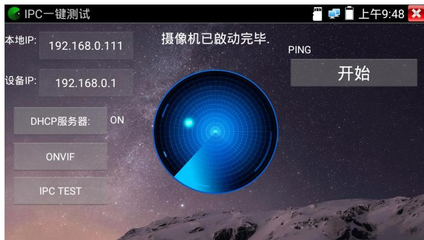
**本机 IP:** 仪表当前的 IP 地址，在搜索到设备 IP 的同时，仪表将自动修改本机 IP 与设备 IP 同一网段。
