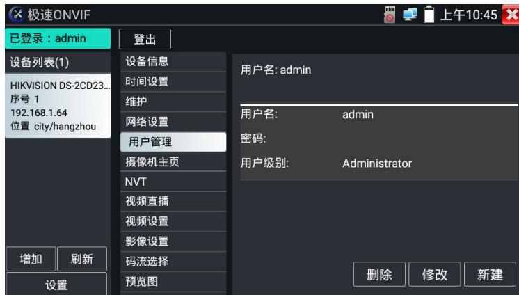
**网络设置：**点击“网络设置”，可对修改网络摄像机的IP地址。有些摄像机不接收修改IP地址，故在保存后网络摄像机IP地址不会变化。
