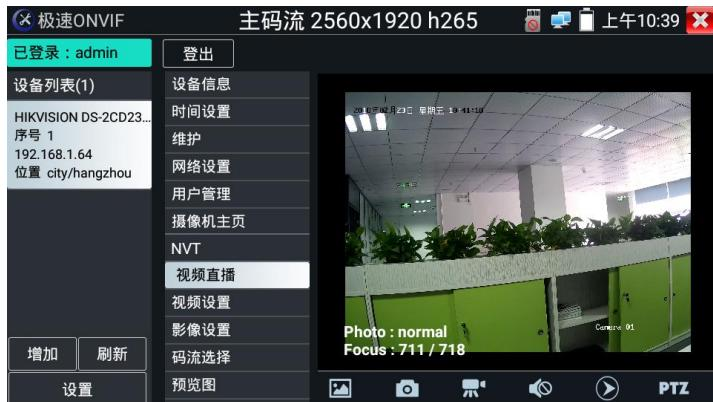
**云台控制：**手指在图像显示区域向左、右、上、下滑动，以及两手指向外滑动扩大、向内缩小，网络球机做相应的转动动作。图像显示区域的左上角，显示云台转动方向。
