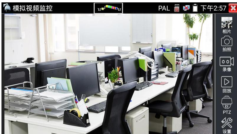
进入模拟视频监控测试界面，当有图像输入时，显示摄像机送过来的图像。在接收到摄像机或快球的图像时，可轻触上面菜单条的
