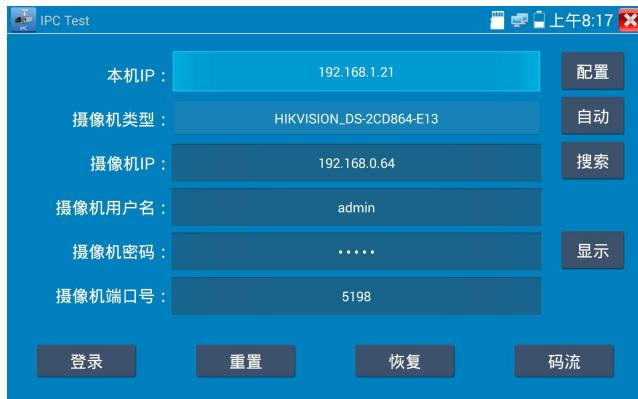
**本机IP：**指本仪表的IP地址，仪表支持多网段的IP摄像机测试。点“配置”，进入仪表系统设置的“IP设置”界面，设置本仪表的IP地址，可在高级选项中添加不同网段的IP地址，点“设置”保存，提示设置成功，点 关闭设置，返回到IPC Test界面。
