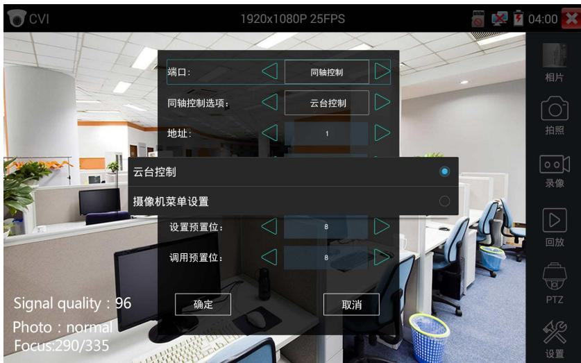
输入调用球机菜单的地址码，参数设置完成后，直接按键盘“光圈+” 或点击屏幕中的
