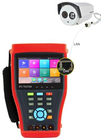
**注：**对于不提供外接电源的IP网络摄像机，因为它只支持PoE供电功能，可通过仪表的LAN端口为该网络摄像机提供PoE供电，供电时必须断开网络交换机与仪表的连接，即仪表的PSE端口不能连接任何网线。
