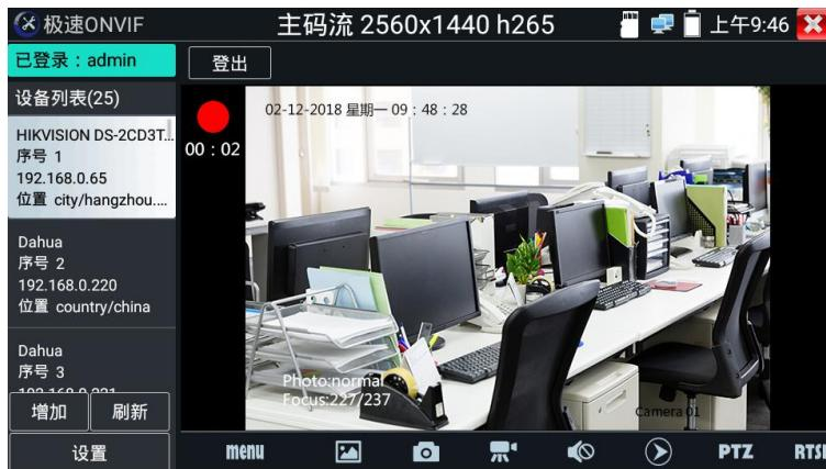
**回放:** 轻触底部工具栏的“回放”图标，显示录像文件，双击该文件进行播放。轻触右上方的 关闭并返回上层菜单。
