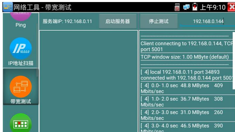
网络带宽测试，也可以用一个仪表和电脑进行测试。在电脑上安装网络带宽测试软件，作为测试端或服务器，与仪表进行对测。
