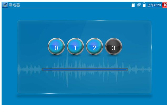
按配套的寻线器电源开关，寻线器开机，使用配套的寻线器寻找线井中的线缆，用寻线器头部铜针放置在每条线缆上，当寻线器发出最清晰的规则响声时，该线缆就是与仪表主机相连的线缆。
