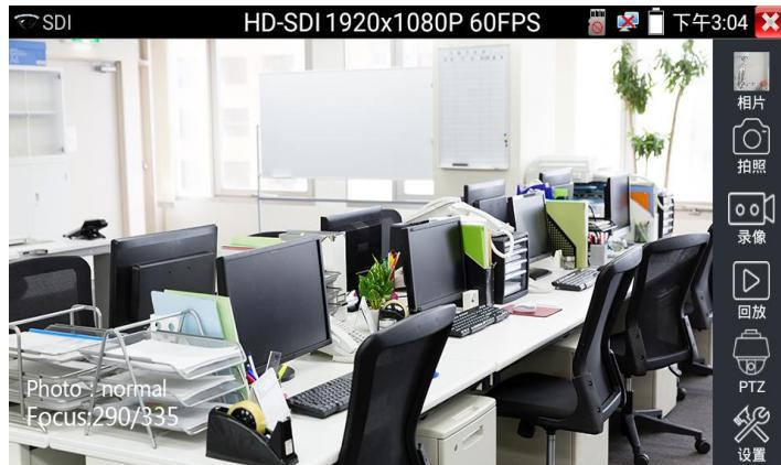
仪表接收到SDI摄像机图像，同时可以通过HDMI输出端口将图像送往高清电视机，可当SDI到HDMI转换器功能。
