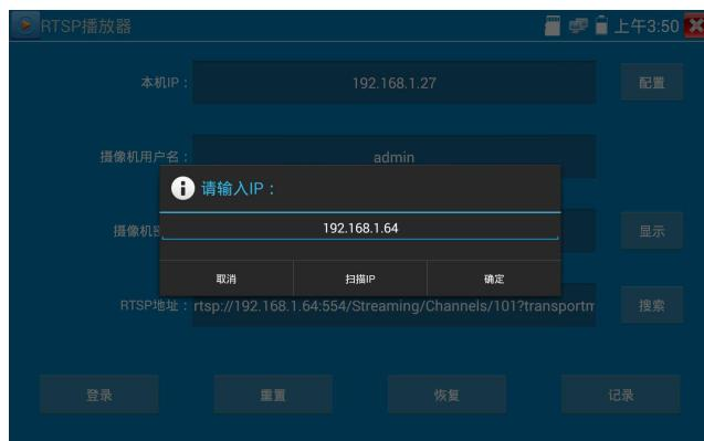
选择显示图像的码流类型，点击确定可观看图像（当摄像机分辨率大于 4K 的时候，可选用分辨率较小的子码流，此时可以流畅的观看图像）
