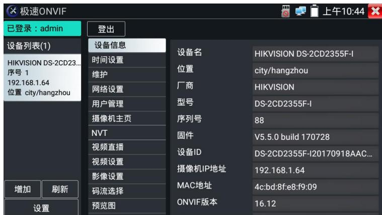
**时间设置：**点击“时间设置”，选择“手动设置”可对摄像机时间进行设置。
