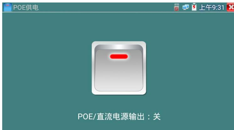
仪表直流电源输出开启，退出电源输出界面后，PoE电源处于开启状态，仪表上面的菜单条一直悬浮“48V已打开”，直到仪表休眠或进入电源输出功能界面点击关闭电源输出。
