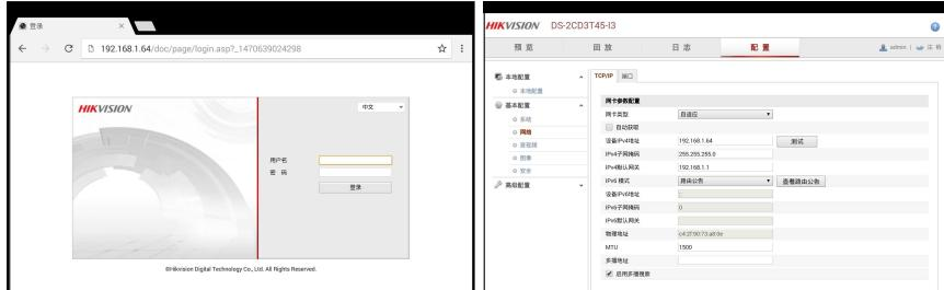
网络摄像机和仪表必须同一网段，浏览器才能登陆网络摄像机。如果通过浏览器修改网络摄像机的地址后，网络摄像机的IP地址与仪表地址不同网段，请等待会话结束并点击
