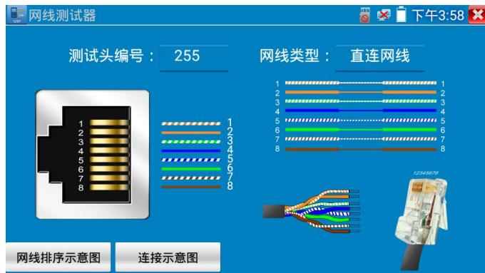
独创 2 芯至 8 芯线路测试，任意两线接通，即可测试显示线序排列、通断情况，以及显示寻线器的编号（默认255）。使用多个不同编号的寻线器，利用测试仪对寻线器编号的读取功能，便于机房线头寻找与排序。随机附送网线测试小盒或寻线器\*（\*定制功能型号见附表）一个。
