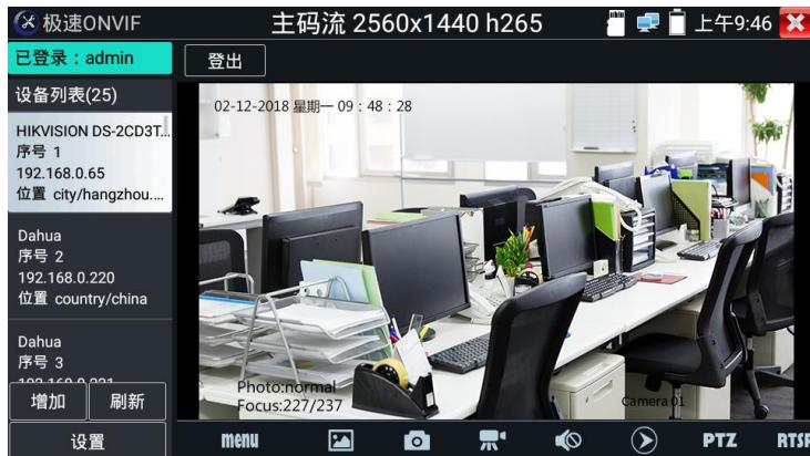
**拍照：**轻触底部工具栏的“拍照”功能，仪表截取当前显示的图像，并存储于SD卡中。
