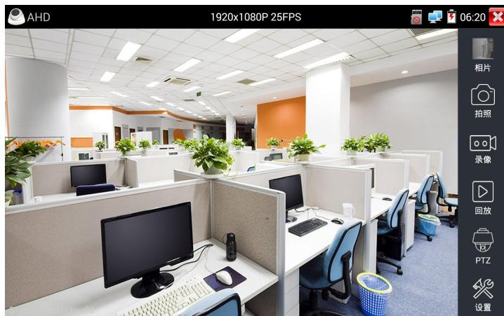
仪表接收AHD图像时，上面菜单条显示该图像的分辨率。手指快速连续两次轻触屏幕，全屏显示图像。仪表支持分辨：
