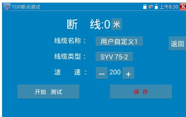
2. 点击线缆类型，选择需要校准线缆的类型。视频BNC线缆一般选用“BNC”，而通信专用的75-2线类请选“SYV 75-2”。
