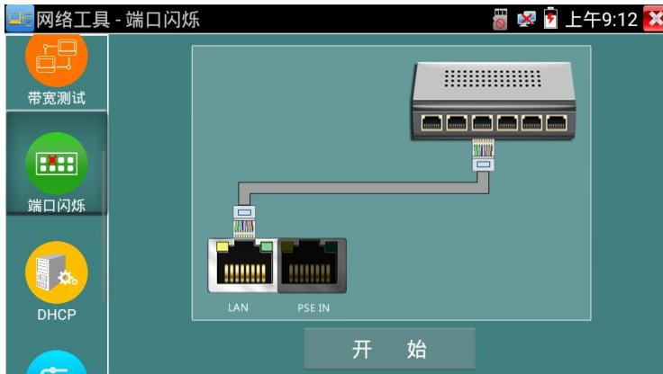
仪表开始发送闪烁信号之前，与仪表连接的端口建立连接通信，正常通信时，仪表屏幕显示的交换机端口图标会按一定频率闪烁；如果无法正常通信（如网线没接好），交换机端口无任何变化
