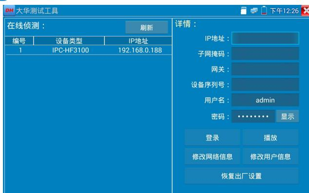
选中“在线侦测”栏目的摄像机，如果摄像机支持非验证方式登陆，无需登陆，直接点击播放，可观看摄像机图像。
