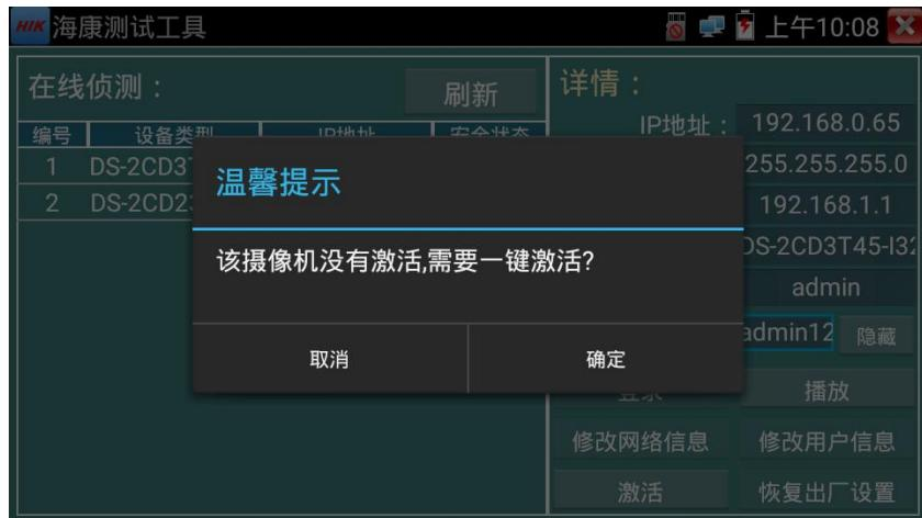
2. 输入激活密码：按要求输入新的密码，点击“确定”可激活摄像机。
