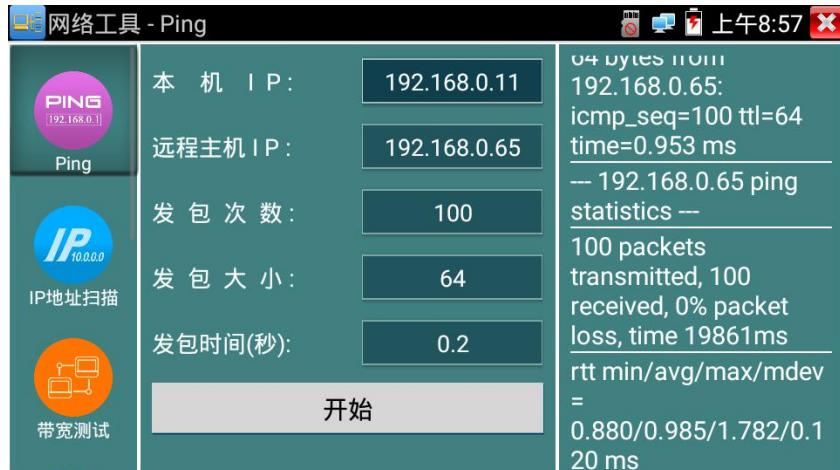
**实用性:** 维护网络设备时，最常用的方法是用PING测试该设备工作是否正常、IP地址设置是否正确，IP摄像机或其他网络设备可以被PING得通，才能进行正常网络通信。PING测试时，第一个包可能会丢包，这是正常现象。
