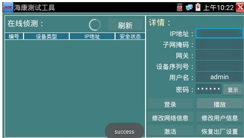
4. 激活后，新款海康摄像机需要开启onvif协议后才能修改网络信息，浏览图像，新增检测新款海康摄像头是否开启ONVIF协议功能，如果没有开启可以链接到海康摄像头主
