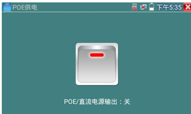
仪表直流电源输出开启，退出电源输出界面后，PoE电源处于开启状态，仪表上面的菜单条一直悬浮“48V已打开”，直到仪表休眠或进入电源输出功能界面点击关闭电源输出。
