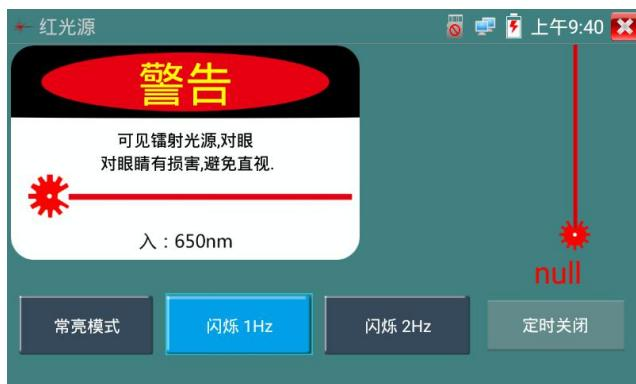
在主界面将VFL功能打开后，点击“闪烁1Hz”或“闪烁2Hz”按键，则VFL进入脉冲发光模式，红光按一定频率发出。再次点击该按键可退出测试。
