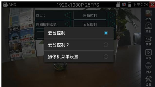
同轴控制选项，选择“云台控制”或“云台控制-2”进行云台控制。（AHD摄像机的云台控制有两种不同指令，如果不能进行云台控制，请切换另一种指令）
