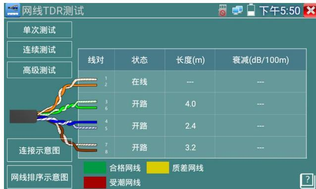
**单次测试：**测试线缆状态、长度和衰减。
