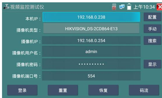
**本机IP：**指本仪表的IP地址，需要把本机ip改成跟摄像机ip同一个网段，仪表支持多网段的IP摄像机测试。点“配置”，进入仪表系统设置的“IP设置”界面，设置本仪表的IP地址，可在高级选项中添加不同网段的IP地址，点“设置”保存，提示设置成功，点
