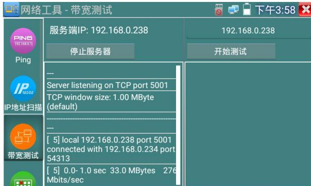
**2. 开始发包测试：**在发包测试端填写对端服务器的IP地址，点击“开始测试”。
