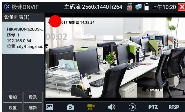
**回放:** 轻触底部工具栏的“回放”图标，显示录像文件，双击该文件进行播放。轻触右上方的 关
