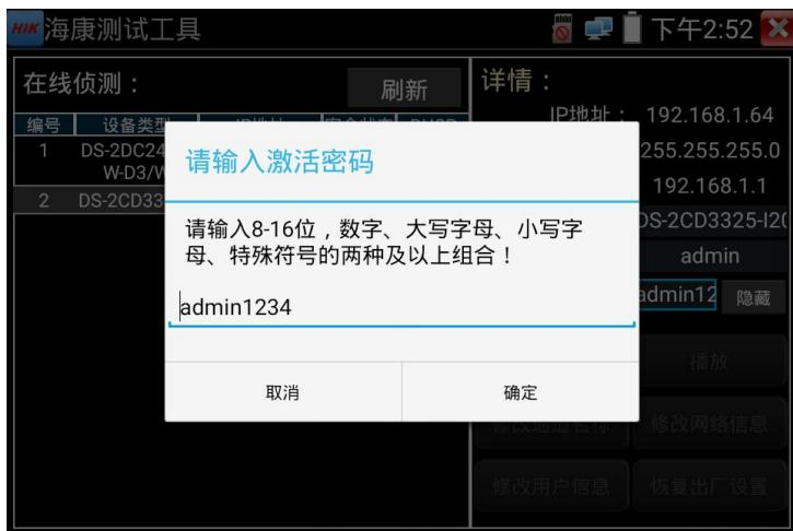
**3. 确认激活密码，完成激活：**确认密码，点击“确定”完成激活已激活的摄像机，需要在右边输入摄像机的用户名和密码才能操作其它设置。
