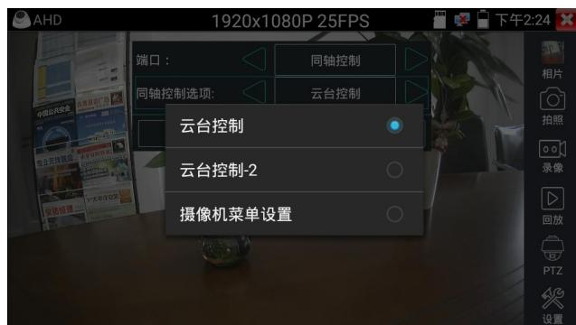
AHD摄像机同轴控制不需要进行参数设置即可进行云台控制。
