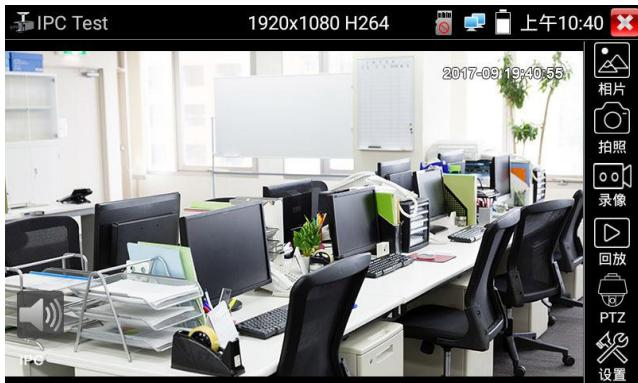
RTSP的图像显示界面，与ONVIF工具的“视频菜单”图像操作一样。同样具备视频图像放大、拍照、录像、相片浏览、录像回放、存储设置等功能，功能的操作一致，请参考ONVIF工具的“视频菜单”操作。
