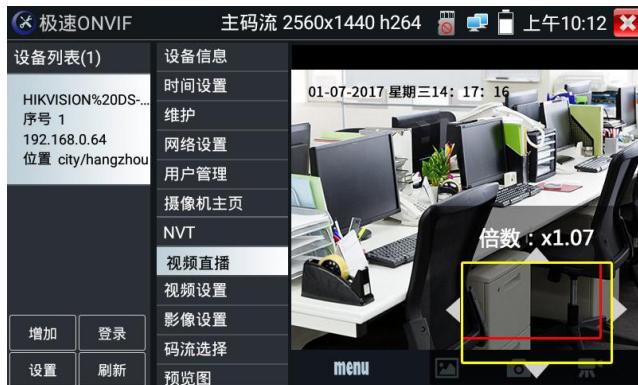
图像放大状态时，如果不用触摸操作，也可按键操作。按 **变倍+** 图像放大；按 **变倍-** 图像缩小；按上下左右方向键，移动图像。
