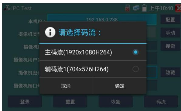
**摄像机IP地址：**输入IP网络摄像机的IP地址。点击“配置”添加不同网段的IP地址，仪表可测试多网段的网络摄像机。点击“搜索”，可自动扫描IP网络摄像机的IP地址，找到IP地址后，显示
