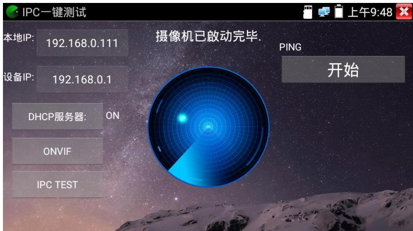
**本机 IP:** 仪表当前的 IP 地址，在搜索到设备 IP 的同时，仪表将自动适配到摄像机的 ip 网段。
