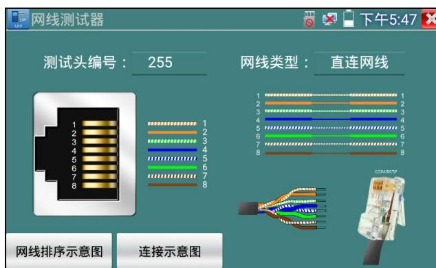
独创 2 芯至 8 芯线路测试，任意两线接通，即可测试显示线序排列、通断情况，以及显示寻线器的编号（默认255）。使用多个不同编号的寻线器，利用测试仪对寻线器编号的读取功能，便于机房线头寻找与排序。随机附送网线测试小盒或寻线器\*（\*定制功能型号见附表）一个。
