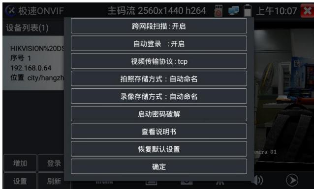
**跨网段扫描:** 工程宝出厂一般都是默认关闭的，建议使用的时候点成开启，极速ONVIF就可以跨网段搜索摄像机
