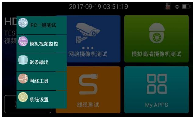
**快捷菜单设置：**长按“所有应用”中的功能，将功能设置为快捷应用，长按“快捷应用”中的功能，将该快捷应用删除。
