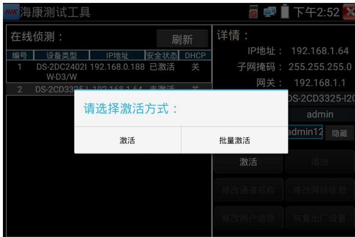
**2. 输入激活密码：**按要求输入新的密码，点击“确定”可激活摄像机，你输入的密码就是摄像机的密码，以后就用这个密码来看图像。
