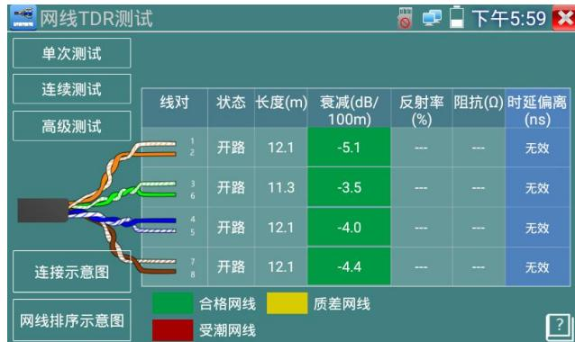
**高级测试：**测试线缆状态、长度和衰减、反射率、阻抗和时延偏离等参数。
