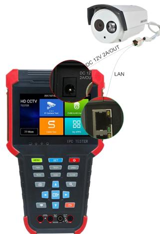
**注：**对于不提供外接电源的IP网络摄像机，因为它只支持PoE供电功能，可通过仪表的LAN端口为该网络摄像机提供PoE供电，供电时必须断开网络交换机与仪表的连接，即仪表的PSE端口不能连接任何网线。
