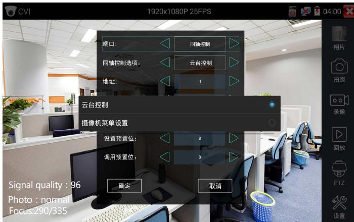
输入调用球机菜单的地址码，参数设置完成后，直接按键盘“光圈+”或点击屏幕中的“进入菜单”，可调出球机主菜单。（有部分摄像机点击“进入菜单”后无法直接打开菜单，需再点击键盘上的“确定”或屏幕上的“确定”键（
