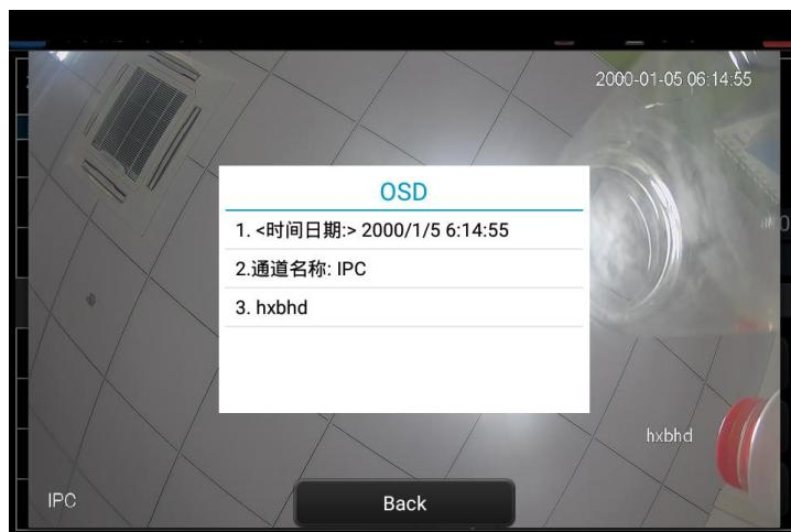
选中通道名称后，可以进行通道名称编辑、显示位置修改和字体大小的切换。“内容位置”选中“默认位置”则不进行修改，选中“自定义”可任意调整通道名称显示位置。点击“确定”后将出现效果图，按键盘返回键或点击屏幕任意区域可返回上一层界面。
