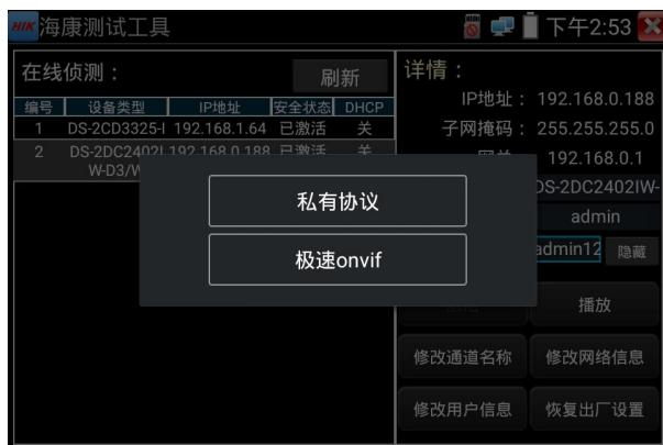
**修改网络信息：**修改摄像机IP地址、子网掩码、网关等参数。
