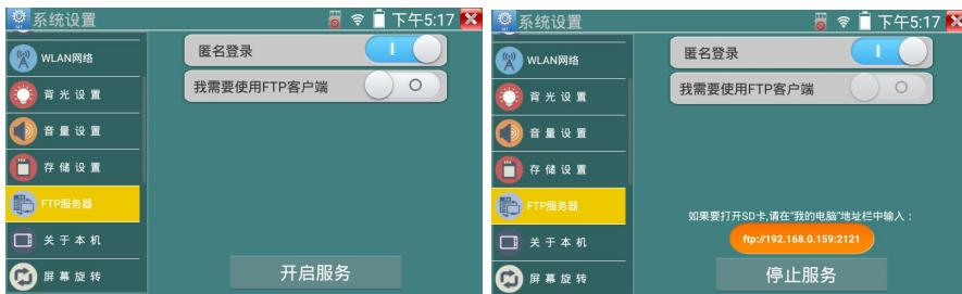
开启FTP服务后，在PC机的“计算机”栏中输入仪表显示的ftp地址（如：<ftp://192.168.0.233:2121>），PC电脑可方便的复制、粘贴文件，而不需要读卡器来读写SD卡文件。
