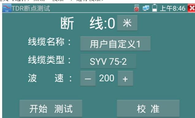
1. 在线缆名称中选“用户自定义1”，点击右下方的“校准”按钮仪表进入校准界面，点击“用户自定义1”可自行定义线缆名称，如：爱谱BNC-5。
