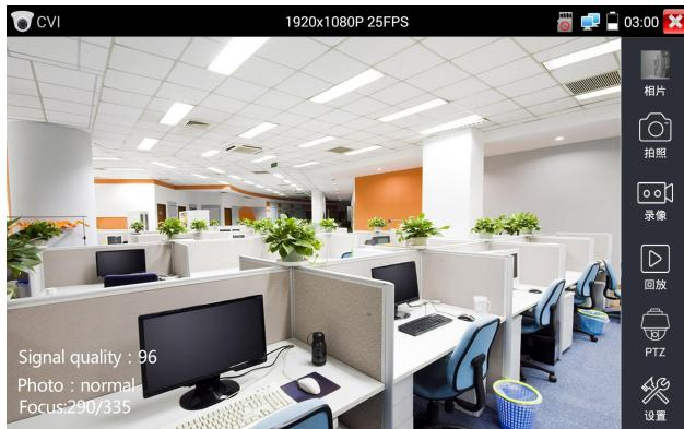
仪表接收HD CVI图像时，上面菜单条显示该图像的分辨率。手指快速连续两次轻触屏幕，全屏显示图像。仪表支持分辨：
