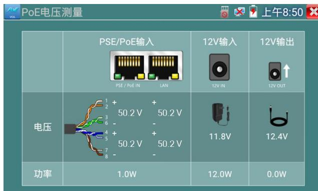
PoE供电设备的端口通过网线接入到仪表左侧的PSE IN端口，受电IP摄像机或无线AP设备接入到仪表左侧的LAN端口，仪表屏幕将显示供电电压的大小及线路连接情况。
