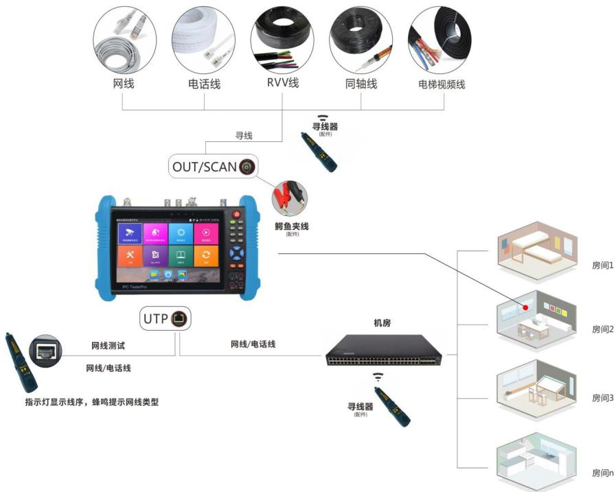
将网线或电话线的一端接入仪表底部的UTP接口，点击进入“寻线器”应用界面，触屏选择“4 数字”选项。寻线器开机后，按“FUNCTION”键，7号指示灯“DIGITAL”闪烁一次表示进入数字模式。此时可在机房或线缆另外一侧进行寻线。
