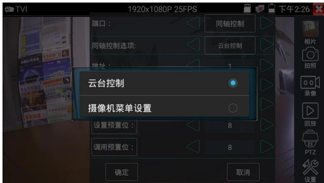
输入调用球机菜单的地址码，参数设置完成后，直接按键盘“确认” 或点击屏幕中的“确认”
