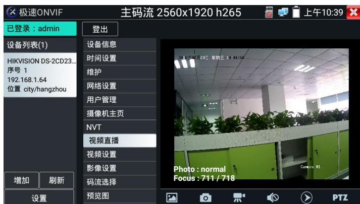
**云台控制：**手指在图像显示区域向左、右、上、下滑动，以及两手指向外滑动扩大、向内缩小，
