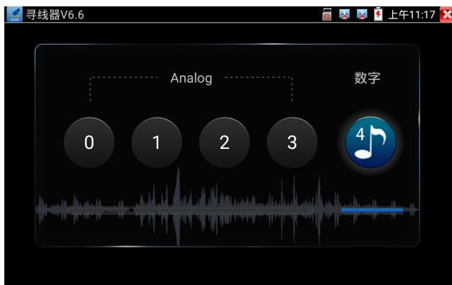
按配套的寻线器电源开关，寻线器开机，使用配套的寻线器寻找线井中的线缆，用寻线器头部铜针放置在每条线缆上，当寻线器发出最清晰的规则响声时，该线缆就是与仪表主机相连的线缆。仪表内置 4 种音频类型供用户选择。搭配的寻线器带 LED 照明小灯，夜晚或者光线暗的地方也可操作。可按寻线器的音量+ -键进行音量调整，电池为两节 7 号电池。
