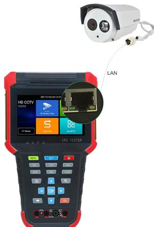
仪表支持PoE以太网供电输出功能，通过以太网RJ45端口的1236引脚传输数据，同时提供48V电源。支持PoE受电功能的网络摄像机，可以直接与仪表连接通信，而不需要外接电源。
