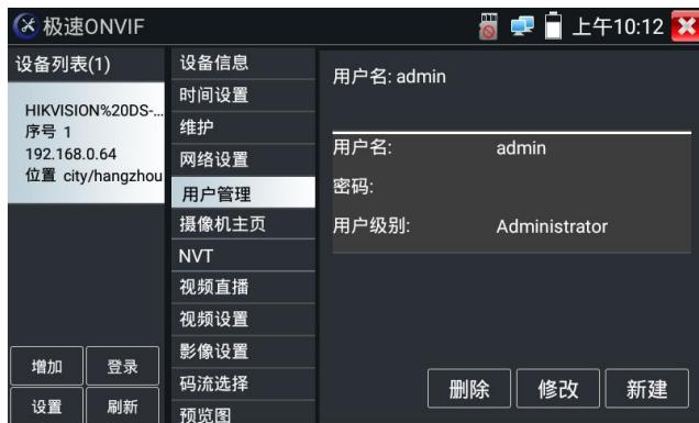
**网络设置：**点击“网络设置”，可对修改网络摄像机的IP地址。有些摄像机不接收修改IP地址，故在保存后网络摄像机IP地址不会变化。
