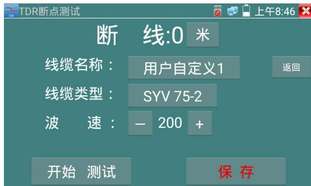
2. 点击线缆类型，选择需要校准线缆的类型。视频BNC线缆一般选用“BNC”，而通信专用的75-2线类请选“SYV 75-2”。
