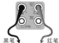
通断测量是验证电路完整性。当电路为导通时，可听到“嘟”声提示，使测试者不必观察屏幕即可完成快速测试。
