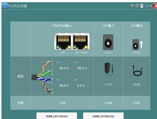
**⚠️ 注意：仪表的12v电源输入接口，不能接入超过17v的电源，否则将损坏机器。**
