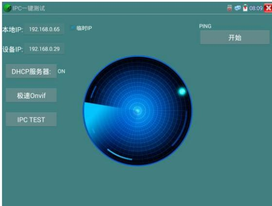
**本机 IP:** 仪表当前的 IP 地址，在搜索到设备 IP 的同时，仪表将自动修改本机 IP 与设备 IP 同一网段。
