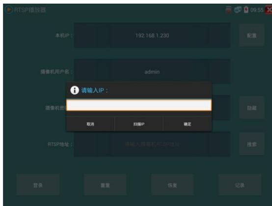
选择显示图像的码流类型，点击确定可观看图像（当摄像机分辨率大于 1920\*1080 的时候，可选用分辨率较小的子码流，此时可以流畅的观看图像）
