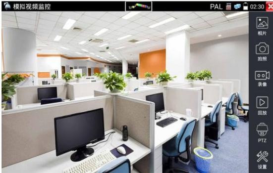
进入模拟视频监控测试界面，当有图像输入时，显示摄像机送过来的图像。在接收到摄像机或快球的图像时，可轻触上面菜单条的
