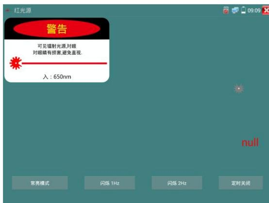
VFL提供四种使用状态——“常亮模式”、“闪烁1Hz”、“闪烁2Hz”和“定时关闭”。点击“常亮模式”按钮，VFL进入常开的打开状态；点击“闪烁1Hz”、“闪烁2Hz”按钮，VFL进入闪烁的打开状态；点击“定时关闭”按钮，VFL立即关闭，可选择定时关闭时间。（时间有：5分钟、10分钟、30分钟、60分钟、120分钟。）用户可根据实际使用情况进行操作。
