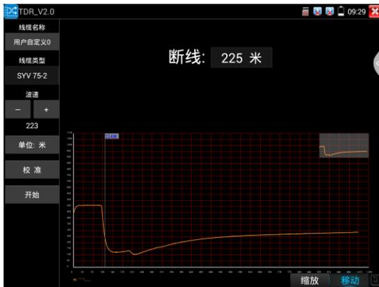
在得到正确米数后，点击“校准”，“请输入新名称”处输入新的线缆名称，线缆类型选择相对应的线缆，波速填入前面测得的波速，按“确定”保存。
