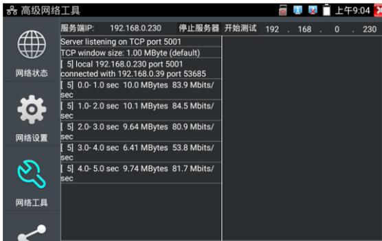
2. **开始发包测试：**在发包测试端填写对端服务器的 IP 地址，点击“开始测试”。
