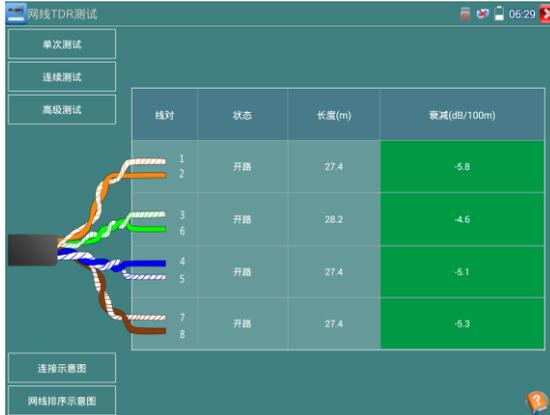
**单次测试：**测试线缆状态、长度和衰减。
