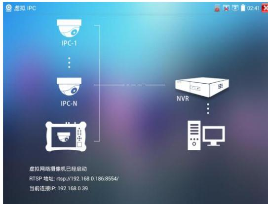
断开网络连接或退出应用时，将自动关闭虚拟摄像机功能。
