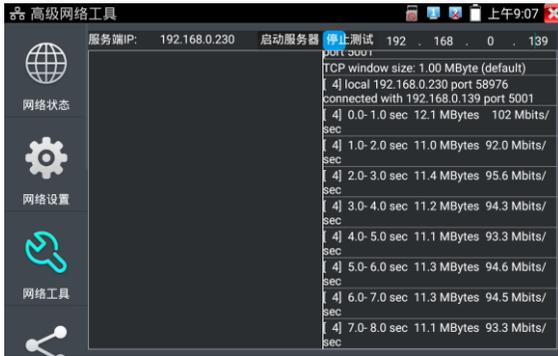
网络带宽测试，也可以用一个仪表和电脑进行测试。在电脑上安装网络带宽测试软件，作为测试端或服务器，与仪表进行对测。如电脑的当服务器，电脑的 IP 地址为：192.168.0.89
