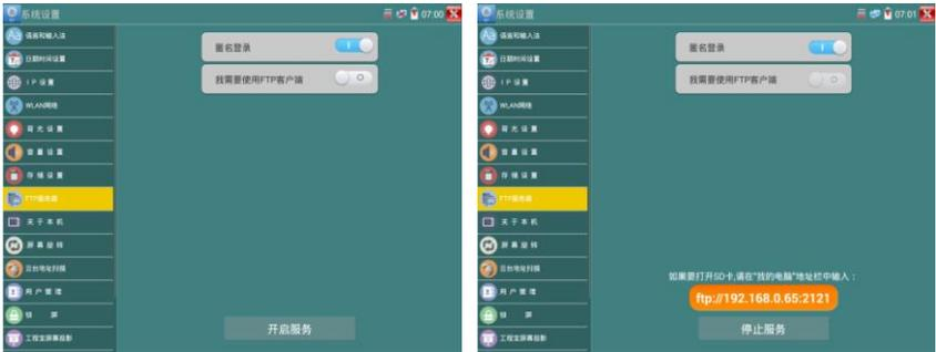
开启FTP服务后，在PC机的“计算机”栏中输入仪表显示的ftp地址（如：
