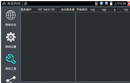
进行网络带宽测试时，必须有一个仪表当服务器或用电脑安装网络测试软件当服务器，另一个仪表发包测试。两个测试仪表必须在同一网段上。
