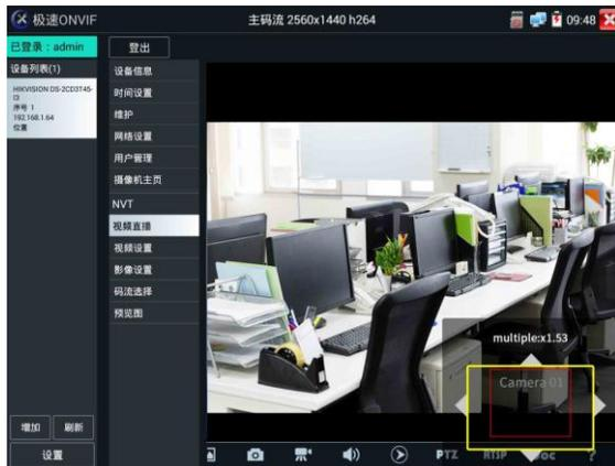
图像放大状态时，如果不用触摸操作，也可按键操作。按 **变倍+** 图像放大；按 **变倍-** 图像缩小；按上下左右方向键，移动图像。
