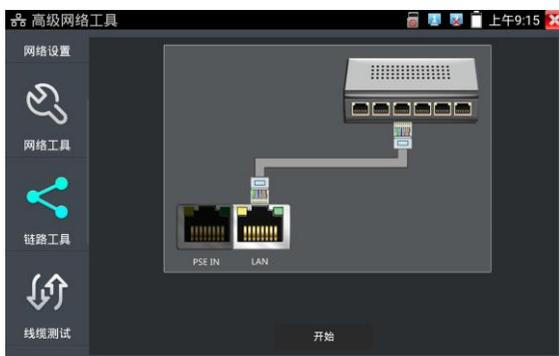
仪表开始发送闪烁信号之前，与仪表连接的端口建立连接通信，正常通信时，仪表屏幕显示的交换机端口图标会按一定频率闪烁；如果无法正常通信（如网线没接好），交换机端口无任何变化。
