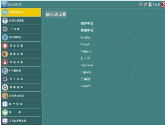
**输入法：**设定仪表的输入法。可根据需要或习惯，安装其他输入法。
