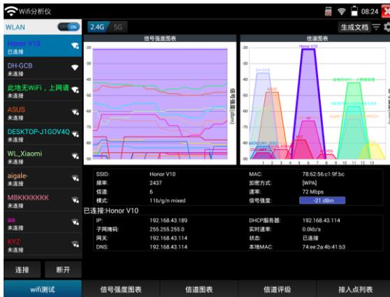
长按 WLAN 列表中的 SSID 号，可修改显示颜色。列表 SSID 号颜色使用默认预设颜色，预设颜色可在设置菜单中进行设置。
