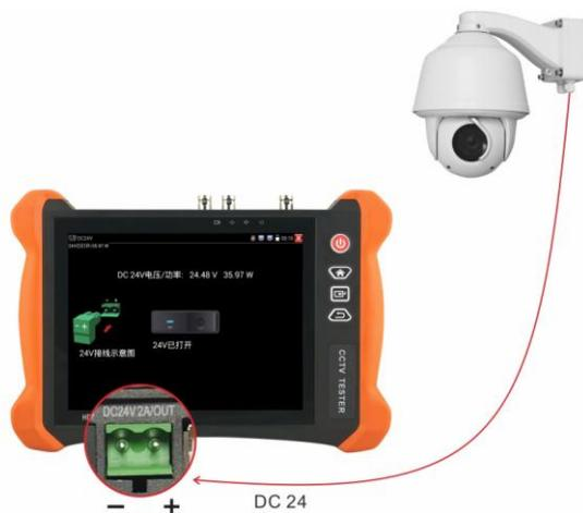
仪表 DC24V 供电输出，必须通过仪表的 [DC 24V] 中的开关按键，控制电源输出和关闭。开启后显示“24V 已打开”，悬浮窗口显示当前实时 24V 供电功率。
