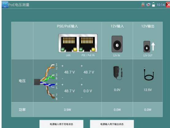
PoE供电设备的端口通过网线接入到仪表左侧的PSE IN端口，受电IP摄像机或无线AP设备接入到仪表左侧的LAN端口，仪表屏幕将显示供电电压的大小及线路连接情况。
