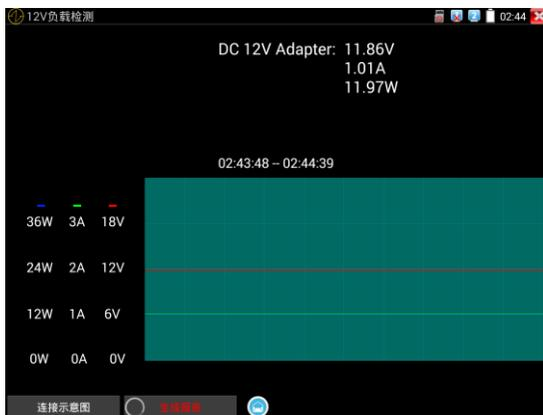
插拔电源适配器或电源适配器、摄像机工作不稳定时，曲线将出现明显的波动
