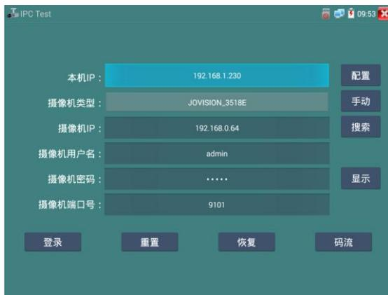
**本机IP:** 指本仪表的IP地址，仪表支持多网段的IP摄像机测试。点“配置”，进入仪表系统设置的“IP设置”界面，设置本仪表的IP地址，可在高级选项中添加不同网段的IP地址，点“设置”保存，提示设置成功，点
