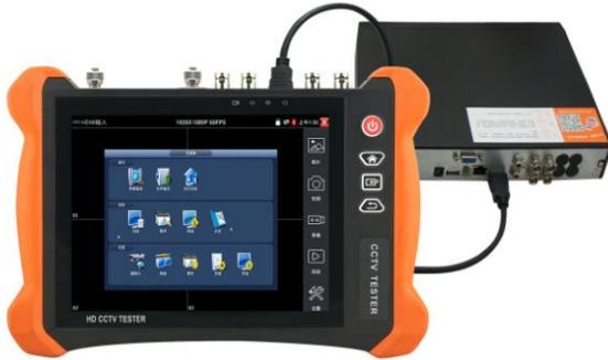
(1) 将硬盘录像机等设备的HDMI输出接口连接到IPC Tester视频监控测试仪顶部的HDMI输入端口，仪表的LCD屏幕将显示硬盘录像机等设备的输出图像；
