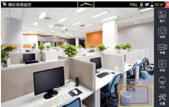
图像放大状态时，如果不用触摸操作，也可按键操作。按
