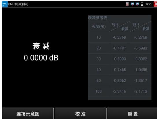
校准后接入待测 BNC 线，仪表将实时检测线缆的传输衰减。
