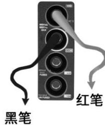
注意：被测电阻应该单独测量，而不是在安装电路中测量。测量线路时，被测线路应该断电。
