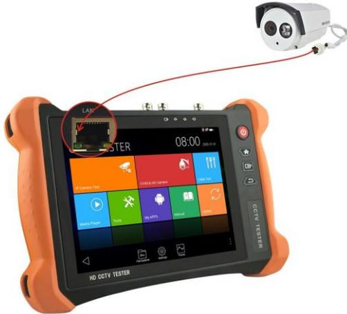
**注：**对于不提供外接电源的IP网络摄像机，因为它只支持PoE供电功能，可通过仪表的LAN端口为该网络摄像机提供PoE供电，供电时必须断开网络交换机与仪表的连接，即仪表的PSE端口不能连接任何网线。
