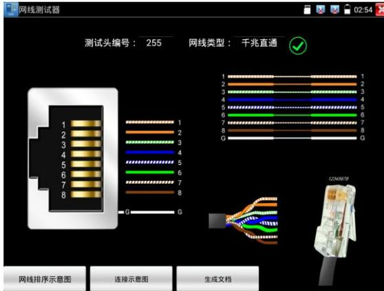
独创 2 芯至 8 芯线路测试，任意两线接通，即可测试显示线序排列、通断情况，以及显示寻线器的编号（默认255）。使用多个不同编号的寻线器，利用测试仪对寻线器编号的读取功能，便于机房线头寻找与排序。随机附送网线测试小盒或寻线器\*（\*定制功能型号见附表）一个。
