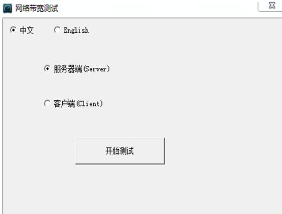
仪表作为测试端，仪表的 IP 地址为：192.168.0.230，与电脑服务器端是同一网段不同 IP 地址。在仪表的测试端填入服务器端的 IP 地址：192.168.0.89，点击“开始测试”进行网络带宽测试。
