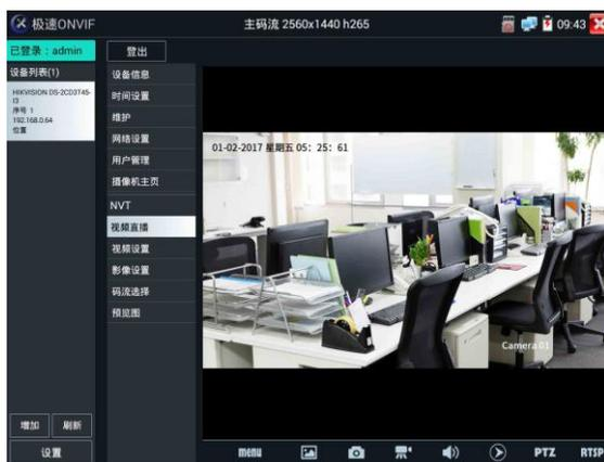
**云台控制：**手指在图像显示区域向左、右、上、下滑动，以及两手指向外滑动扩大、向内缩小，网络球机做相应的转动动作。图像显示区域的左上角，显示云台转动方向。
