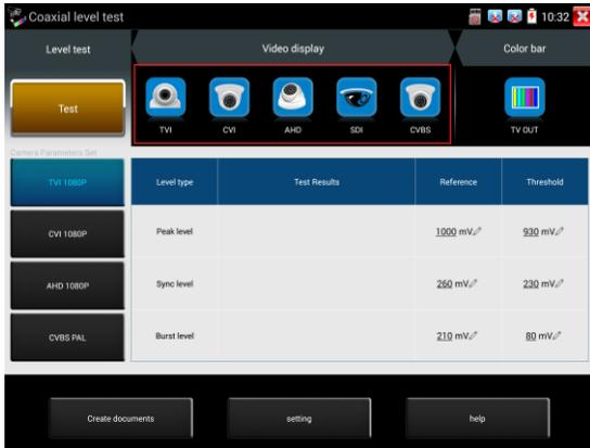
参数设置完成后，点击“开始测试”。仪表将实时检测并显示视频电平的高峰、同步和突发电平值。
