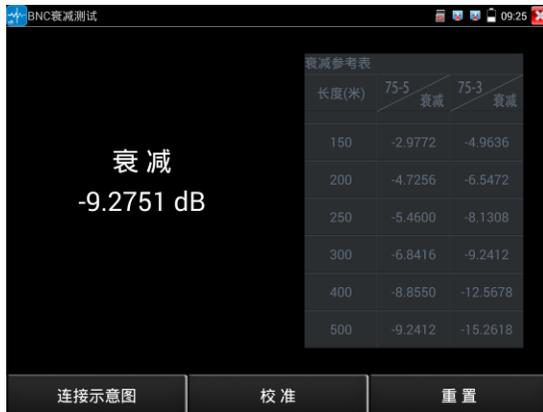
每次测试之前建议先进行校准，检测结果将更加准确。
