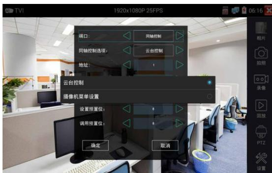
输入调用球机菜单的地址码，参数设置完成后，直接按键盘“确认” 确认 或点击屏幕中的“确认”
