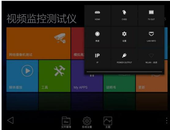
**HDMI：** 开启HDMI输入悬浮窗口，在观看网络摄像机图像时，开启HDMI悬浮窗口，可在观看网络摄像机的同时，观看HDMI输入画面。在任何应用功能界面，都可快速显示HDMI输入图像。
