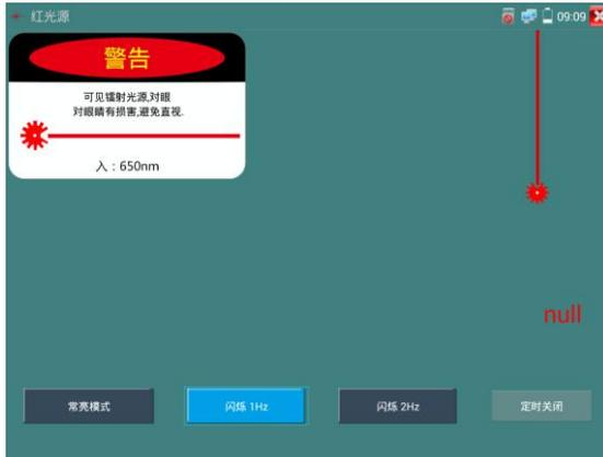
在主界面将VFL功能打开后，点击“闪烁1Hz”或“闪烁2Hz”按键，则VFL进入脉冲发光模式，红光按一定频率发出。再次点击该按键可退出测试。
