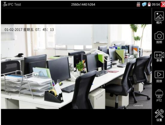
RTSP的图像显示界面，与ONVIF工具的“视频菜单”图像操作一样。同样具备视频图像放大、拍照、录像、相片浏览、录像回放、存储设置等功能，功能的操作一致，请参考ONVIF工具的“视频菜单”操作。
