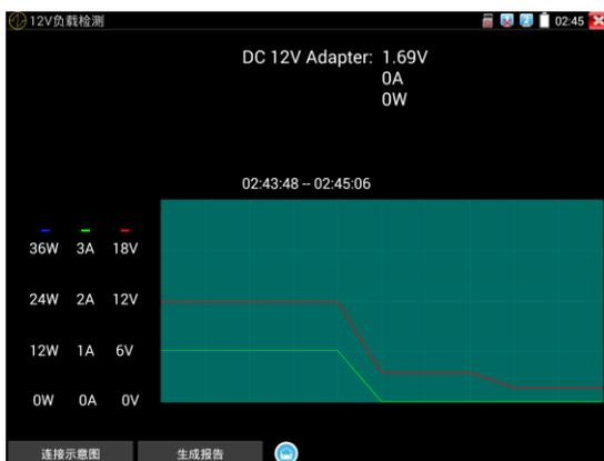
点击“生成报告”，“生成报告”按键上进度圈一直显示转动，此时将记录当前测试的连续结果。
